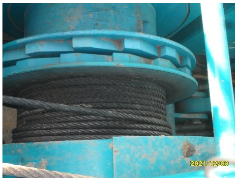
- 상,하부,해머,기복 와이어 점검 / 브레이크 패드점검 - 인디게이터 정상작동 점검 / 후방 카메라 정상작동 점검
