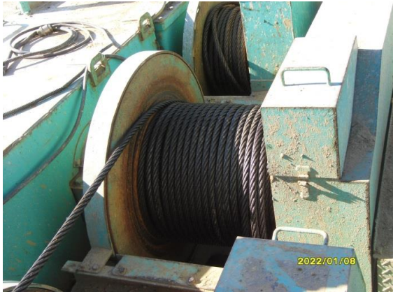
와이어로프 상태, 삼색등 점멸 점검 - 상태 양호
