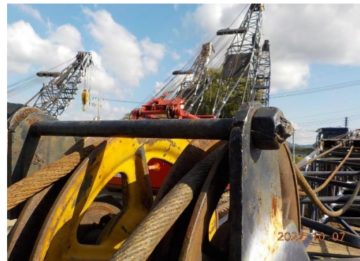
와이어 이탈방지장치 설치 상태 양호
